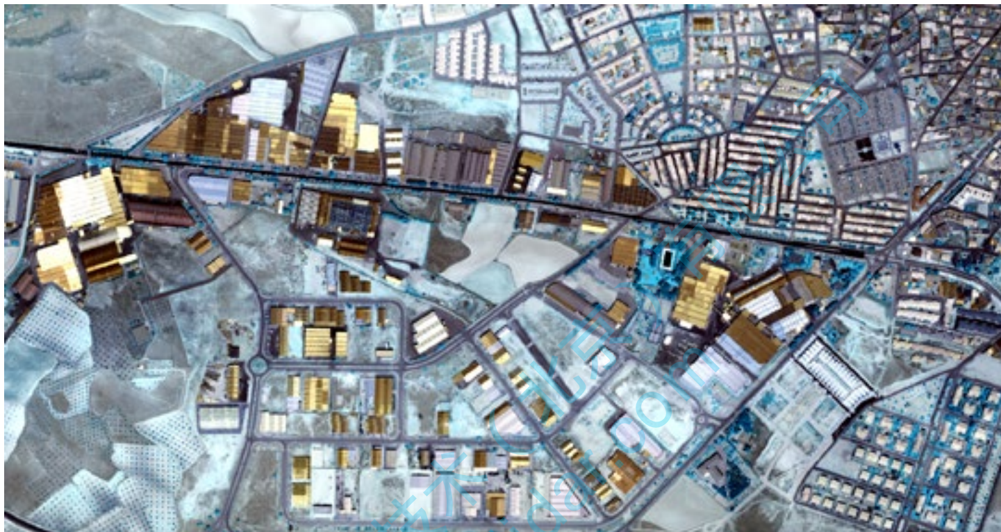
西班牙维拉坎那斯的城区, 粘土瓦屋顶和仿真材料, 1m, SASI-600 SWIR (短波红外)
