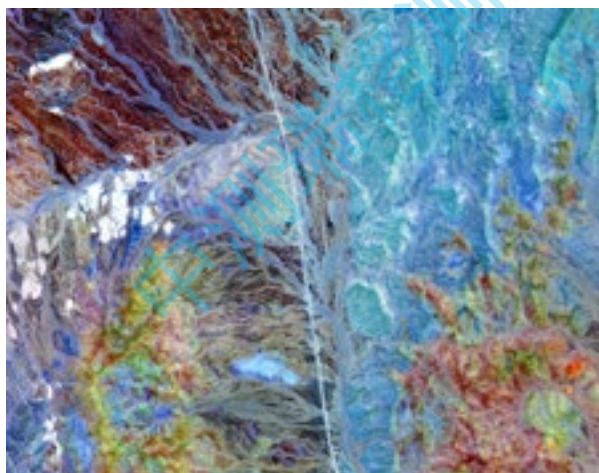
左图:TASI-600 LWIR (长波红外)的比辐射率, 右图附在DEM模型表面的TASI-600辐射率 2010年8月于美国内华达州获取的数据, 2m。
